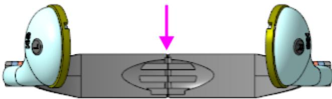
Чтобы обеспечить соединение с ответной частью, сместим зубцы в зеркальной копии.
