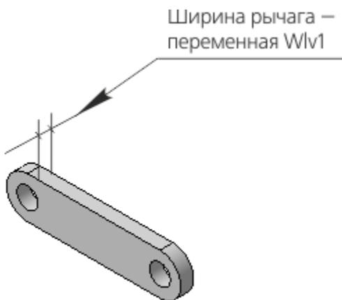
Ширина рычага должна быть связана с переменной **Wlv1** компоновочной геометрии Шарнира.
