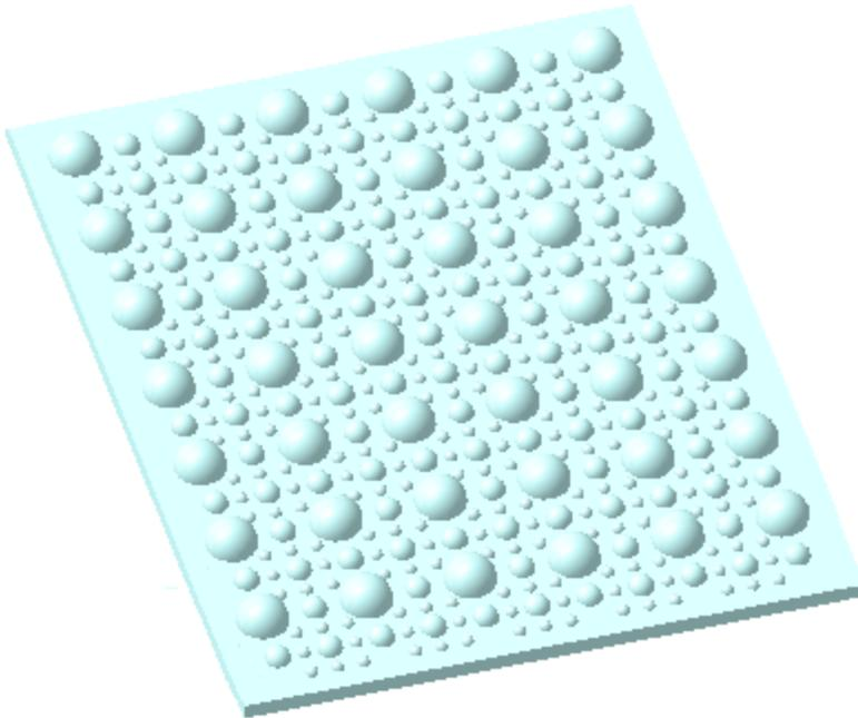
Массив по таблице позволяет копировать объекты с заданием их расположения и параметров геометрии, определяемых табличными данными, в том числе прочитанными из внешнего файла.
