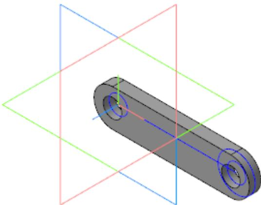
Расстояние выдавливания должно быть связано с переменной толщины Рычага 1 компоновочной геометрии Шарнира — **Wlv1**
