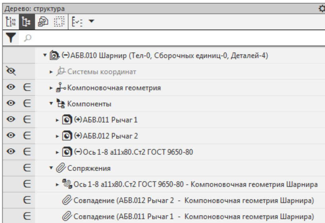
💡 Если на вашем рабочем месте установлен Справочник, из него можно вставить стандартное изделие **Ось 1-8 a11x80.Ст2 ГОСТ 9650-80**. Для этого в разделе *Подшипники и детали машин* Справочника раскройте ветвь *Оси ГОСТ 9650-80*.
