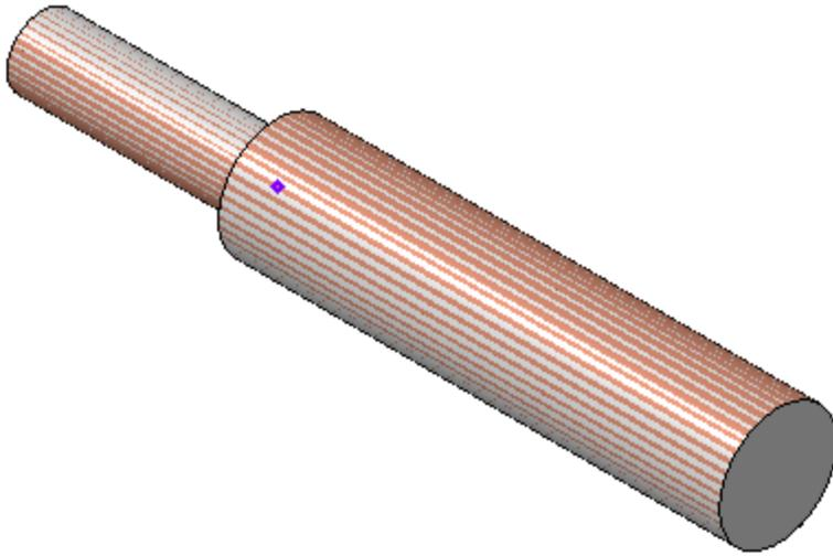
📌 Геометрия Ползуна практически полностью описана поверхностями. Вместо того чтобы повторять операции, можно скопировать поверхности, выполнить команду их сшивки и преобразовать в твердотельную модель.
