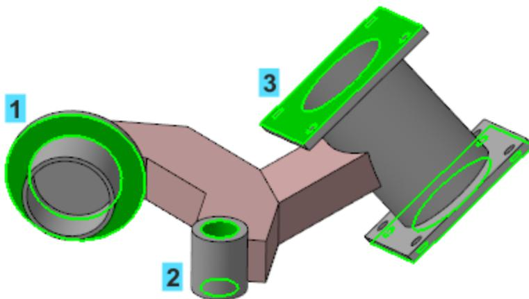
Принимаем решение, что начало координат модели находится в центре полый цилиндрической части Рычага, которая будет устанавливаться на Ось (первое посадочное место). А оси Z модели и цилиндрической части Рычага совпадают.
