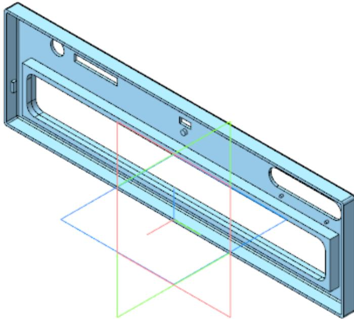
✦ Если требуется создать несколько элементов выдавливания подряд, операции удобно выполнять за один вызов команды **Элемент выдавливания**. Чтобы перейти к следующей операции на основе нового эскиза, нажмите кнопку **Создать эскиз** на Панели параметров или укажите имеющийся эскиз в Дереве. Затем задайте параметры операции.
