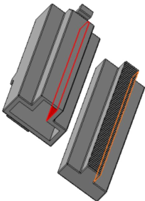
**На расстоянии:** для поверхностей торцов корпуса и подвижной части рейки — в поле **Расстояние** задайте значение **0**.
