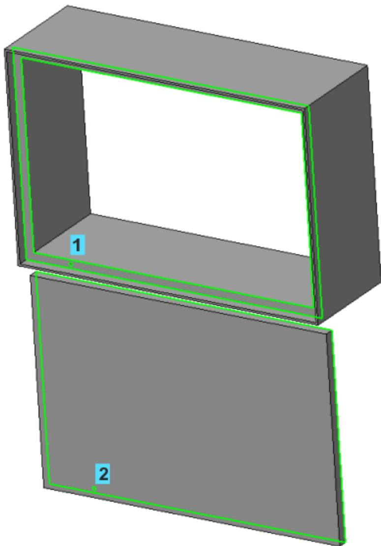
**Совпадение:** для вершины 3 угла паза детали **Корпус**, ближайшей к отверстию, и вершины 4 угла детали **Крышка**, ближайшей к стержню.
