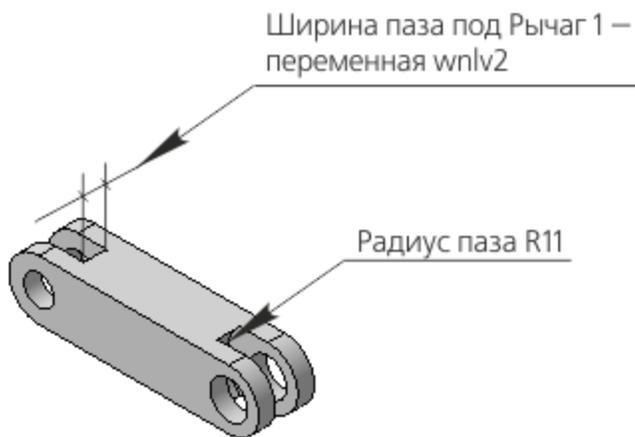
Ширина паза под Рычаг 1 должна быть связана с переменной **wnlv2** компоновочной геометрии Шарнира.
