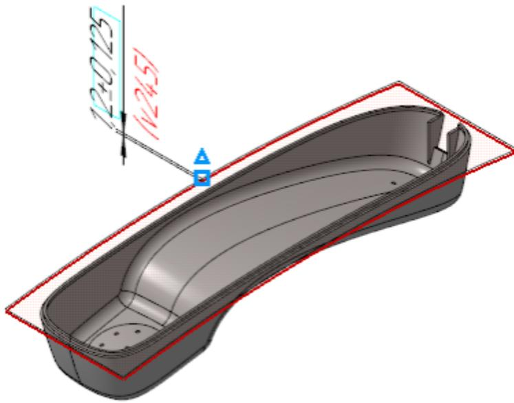
Корпус трубки в сборе
